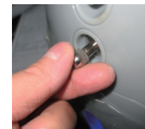
5) Odšroubujte šrouby a nasadte rozhraní rozprašovací trysky, poté otočte
